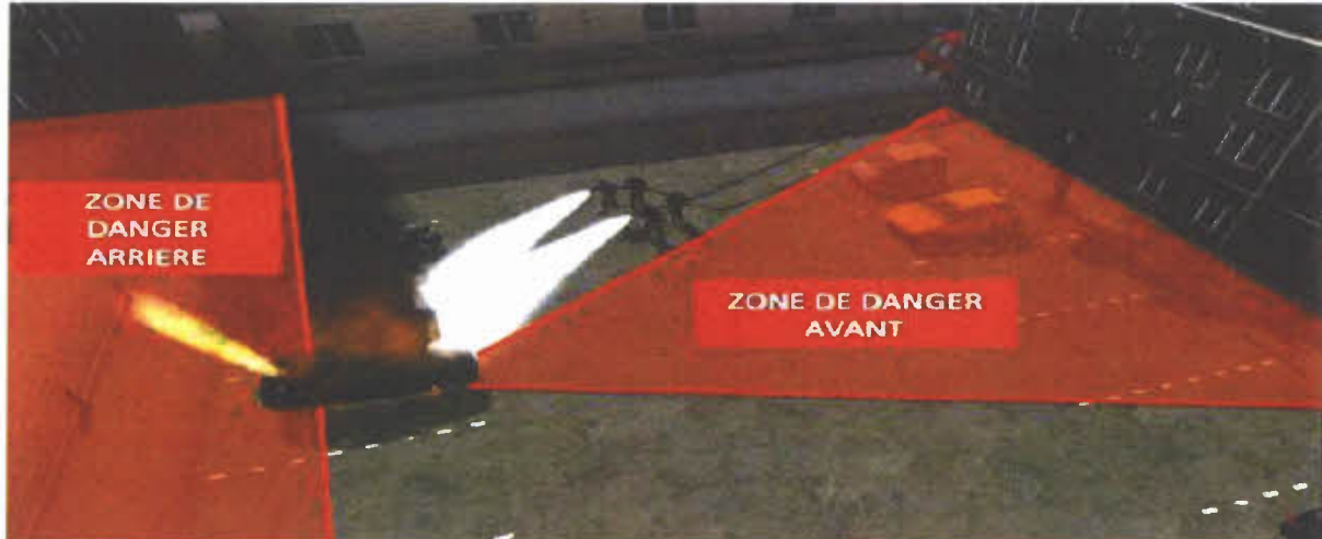
Exemple de feu de VL à l'extérieur avec un jet torche - illustration des zones de danger
