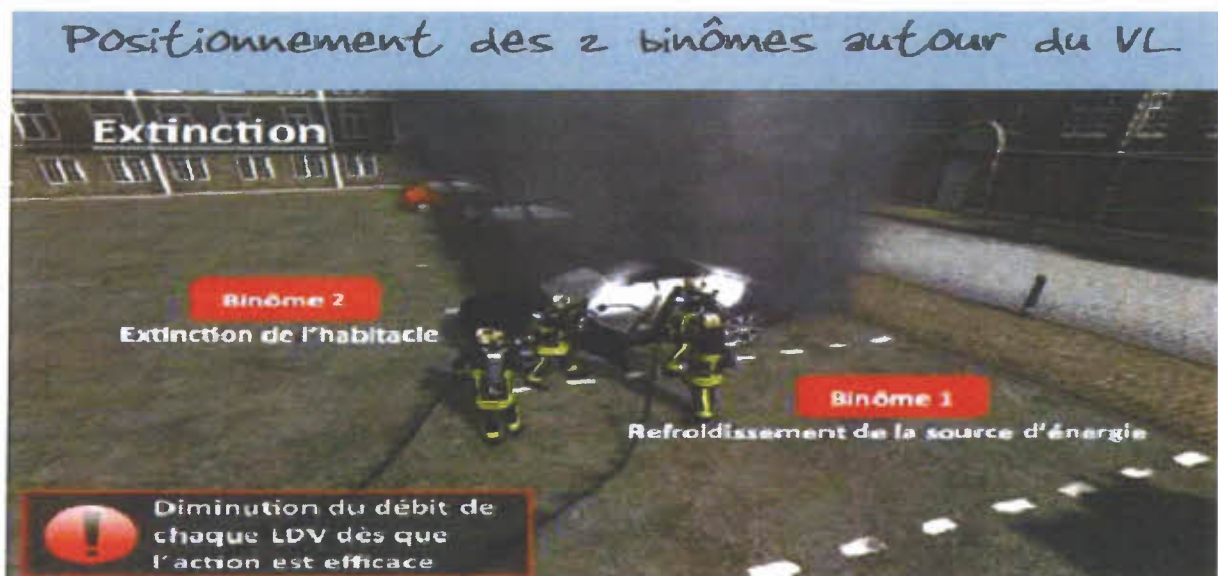
Exemple d'extinction à l'aide de 2 binômes d'attaque
